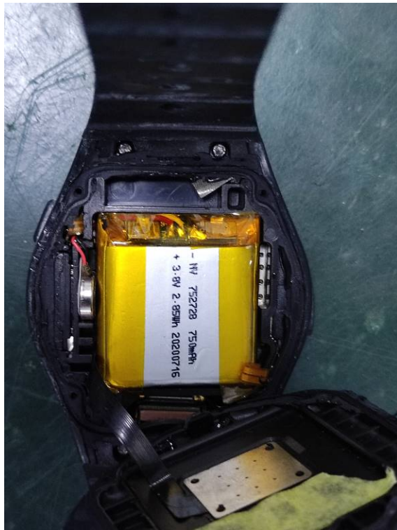
防水试验后检查
